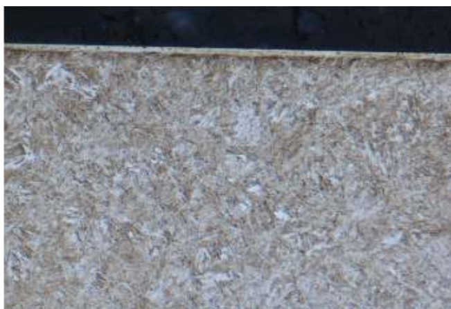
Mitnehmerflansch Serie, Längsschliff – gleichmäßig ca. 1 \mu\text{m} Kaltverfestigt
